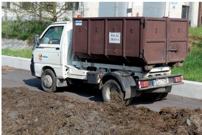
Svoz surovin – užitkové vozidlo Piaggio PORTER S85 s výkonem dieslového motoru 48 kW a nosností 685 kg je vybaveno nástavbou pro svoz kontejnerů. Ocelové kontejnery KOVEX KU 2,6 mají objem 2,6 m<sup>3</sup>
