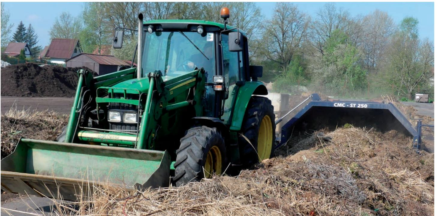
Provozdušňování kompostu – tažený překopávač kompostu COMPOST System CMC – ST 250 s pracovním prostorem (š x v) 2,5 x 1,5 m; výkonnost 500 - 800 m<sup>3</sup>/h podle fyzikálních vlastností zpracovávaných surovin
