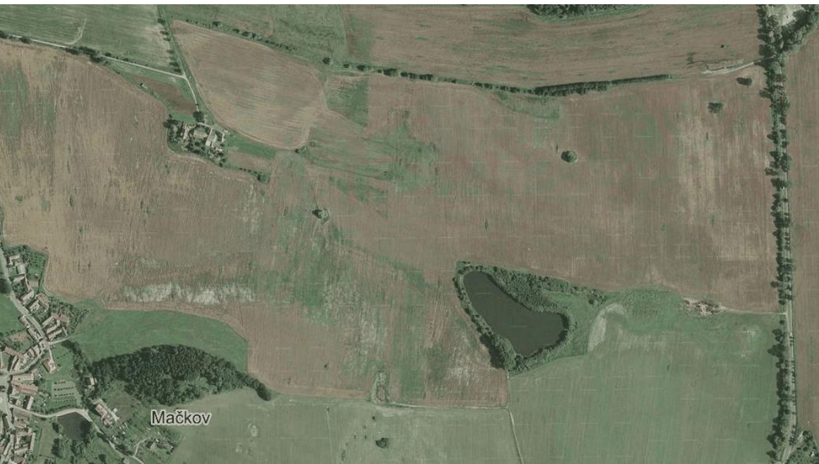
Obrázek 25:Příklad následků působení soustředěného odtoku, rýhové a plošné eroze v lokalitě pod Hněvkovem (zdroj Geodis)
